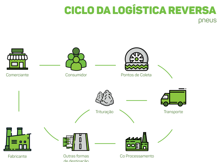
Figura 11. Ciclo do sistema de logística reversa de pneus inservíveis.
