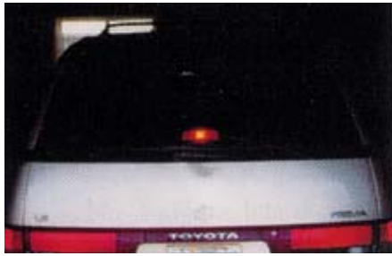
Lâmpada de freio montada no para-brisa traseiro de automóveis.
